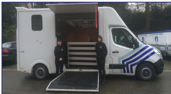
Renault Master permis C, équipé d'une caisse de type poulinière permettant le transport de deux chevaux dos à la route et d'un vestiaire pour les cavaliers.
